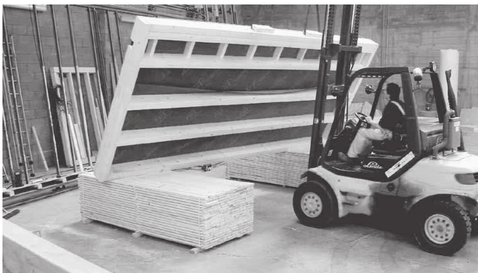
Figura 6. Manipulación de paneles en taller. Autor: Marc Folch
