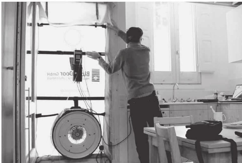
Figura 9. Detalle prueba de hermeticidad. Blower door. Autor: Marc Folch
