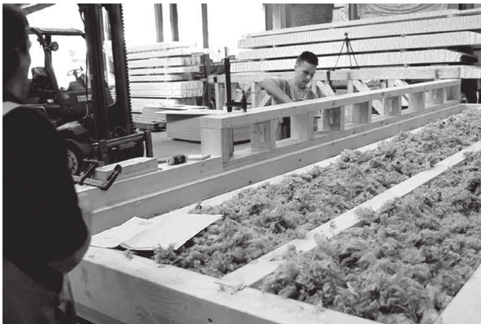
Figura 5. Fabricación de paneles en taller. Autor: Marc Folch
