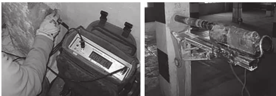
Figura 1. Proceso de análisis de ultrasonidos (izquierda). Momento de extracción de una probeta testigo (derecha). (Fuente: Los autores).
