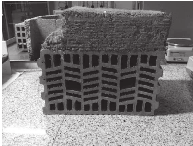
Figura 1. Muestra de ensayo que representa el sistema constructivo termoarcilla de 19 cm de espesor revestida en la zona superior de la fotografía (cara exterior del cerramiento) por 10 cm de tierra puesta en obra mediante proyección (Fuente: autores).
