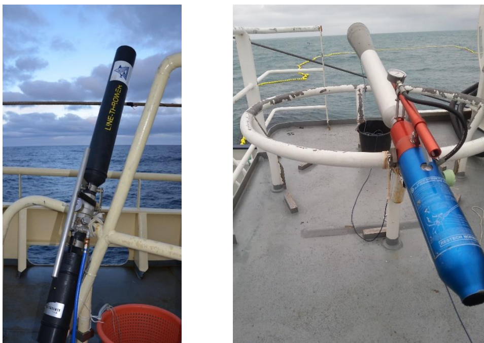
Figur 4. Til høyre den første prototypen av den utskytbare prøvetakingstrålen basert på linekaster fra Vónin på Færøyanne. Til venstre den endelige versjonen av prøvetakeren konstruert med Pneumatic Line Thrower (PLT®) fra Restech Norway AS.
