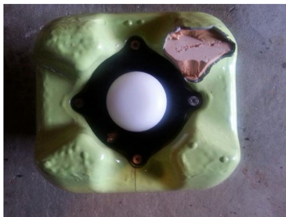
Figur 12 - Versjon 2 av prototypen ble skadet i TriPlex da notlin la seg rundt en av beskyttelsestaggene og slet den i stykker. Dette ble rettet i neste versjon ved å erstatte sestaggene med en sammenhengende kant rundt lyslinsen.
