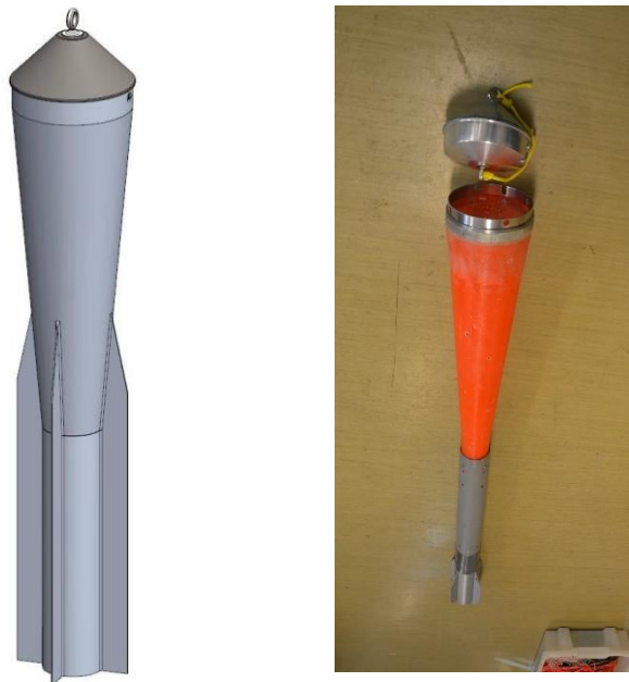
Figur 5. Den endelige utformingen til prosjektilet der prøvetakingstrålen pakkes for utskyting.
