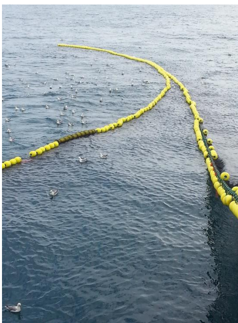
Figur 7. Nota klapper ofte sammen til en smal kile under haling, noe som gjør det vanskelig å plassere prøvetakingstrålen i nota.
