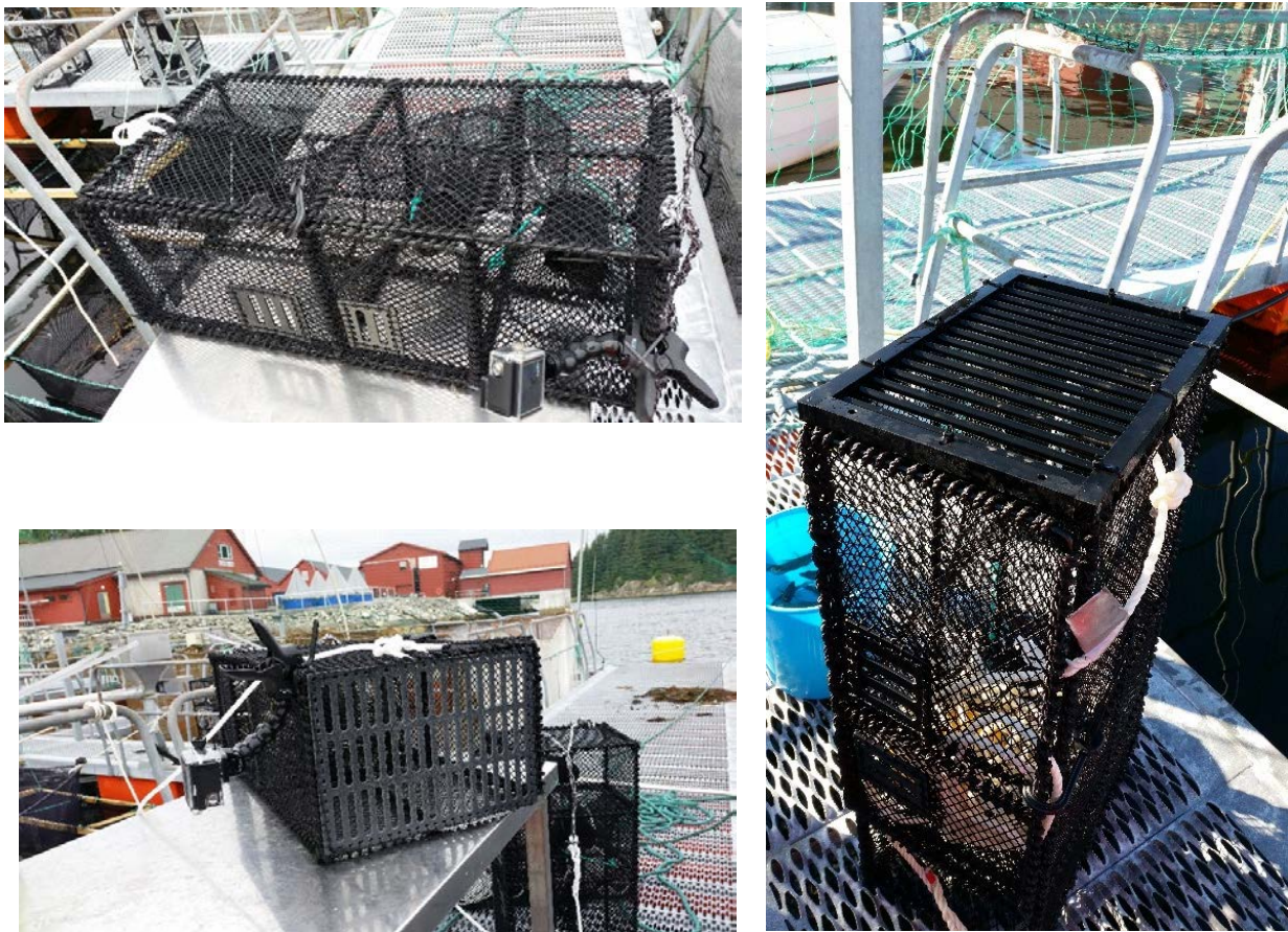
Figur 2. Risttypene brukt i forsøket. Øverst til venstre: standard 3-spalters siderist; nederst til venstre: heldekkende enderist med flate spiler; til høyre: heldekkende enderist med runde spiler.
