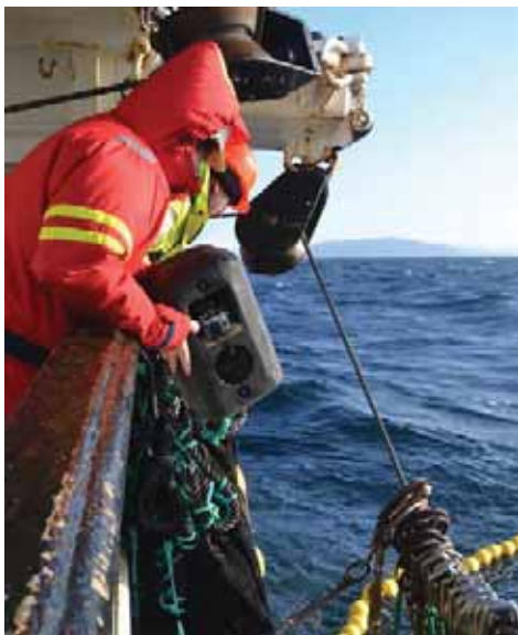
Figur 8. GoPro-kamera i beskyttelsholder festes til geila og er klar for å settes på sjøen.
