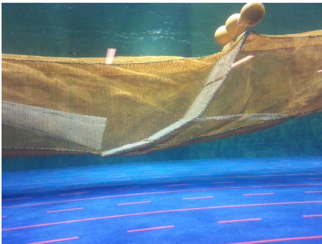
Figur 2. Ristvinkler med 1,5 knops tauefart og 3 stk 11" kuler (ca. 25 kg oppdrift) festet på toppen av 19 mm rist. Ledenett med to parallelle blytau oppå med 0,5 kg/m vekt.
