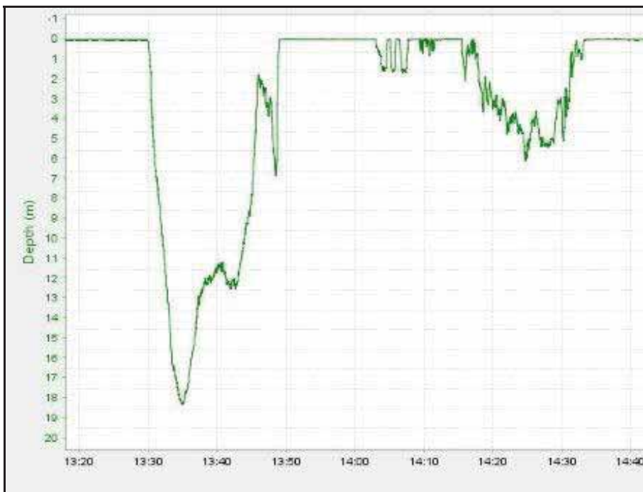
Figur 8. Målinger fra dybdesensor plassert omtrent midt på geila gjennom et notkast. Til venstre ser man hvordan sensoren går ned og dras opp til overflata under setting og kaving. Til høyre ses dybden på utslippshullet når nota åpnes for slipping. Den vertikale åpningen er i dette tilfellet 5 – 6 meter.
