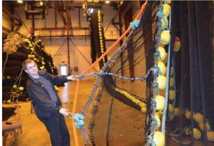
Figur 12. Den ”nye” flåsnurpa ble montert på nota ved Fiskenet i Manger. Det ekstra ”skjørtet” var 1 m høyt, 25 m langt og var montert 30 cm nede på notas garnering.
