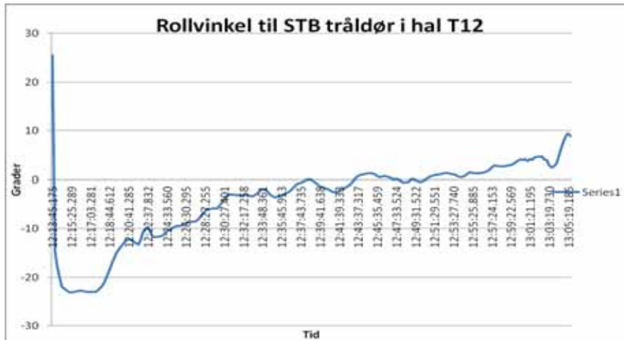
Figur 10. Endring av rollvinkel fra helt åpen til lukket luke oppe i hal T12 (ved negativ rollvinkel ligger tråldøren innover og skjærer oppover og ved positiv utover og skjærer nedover)
