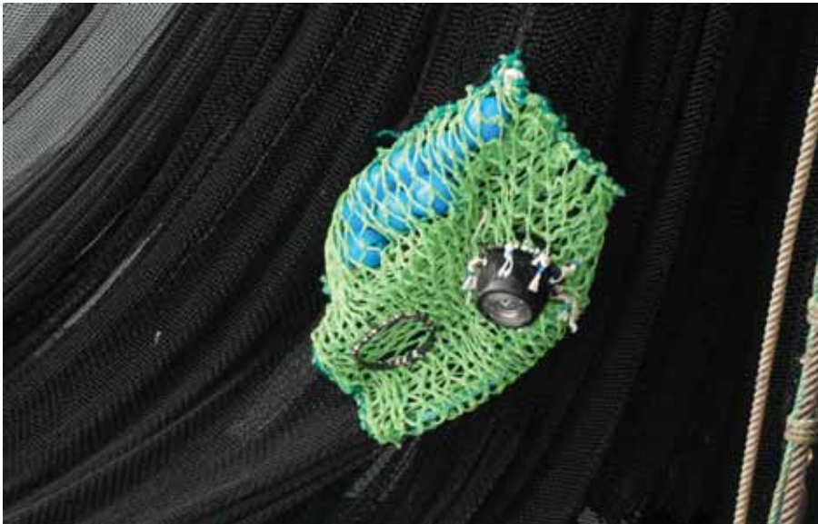
Figur 9b. Notkamera montert i stivt trållin, som igjen er sydd fast i nota ca 40 meter under flåen og ca 200 meter fra ørekallen.
