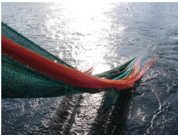
Figur 7. Oppsamlingsposer av PE materiale (rødt) montert på rekefølgen.
