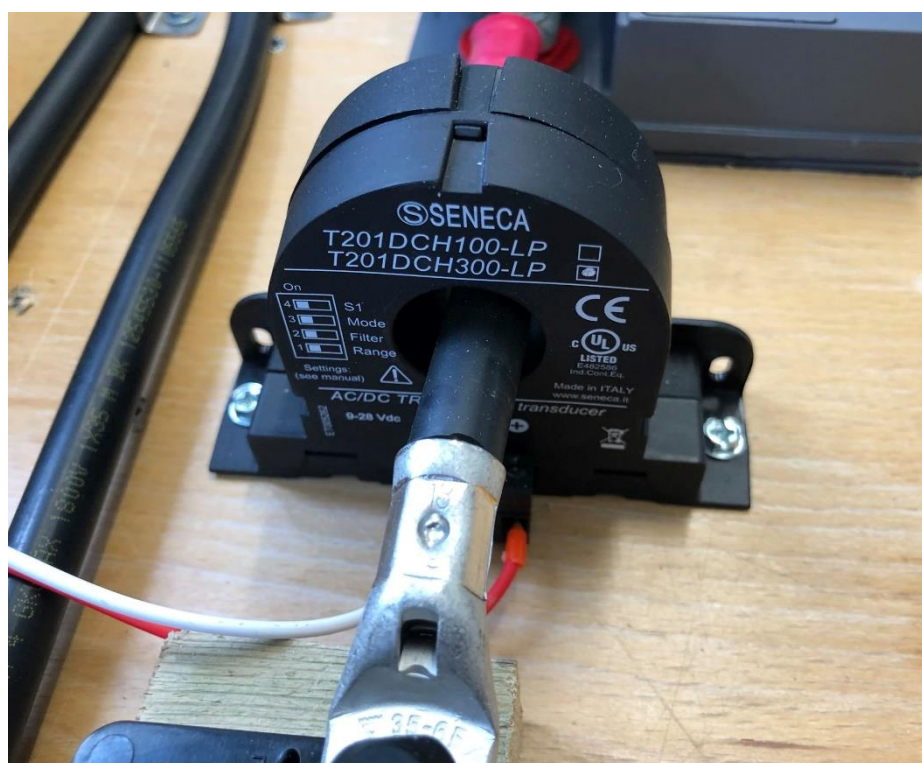
Figur 12: Seneca T201DCH300-LP Hall-elementbasert strømmåler
