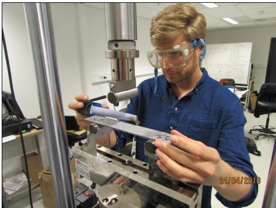
Figur 21- Midten måles opp, slik at prøvestykket ligger sentrert mellom rullene.
