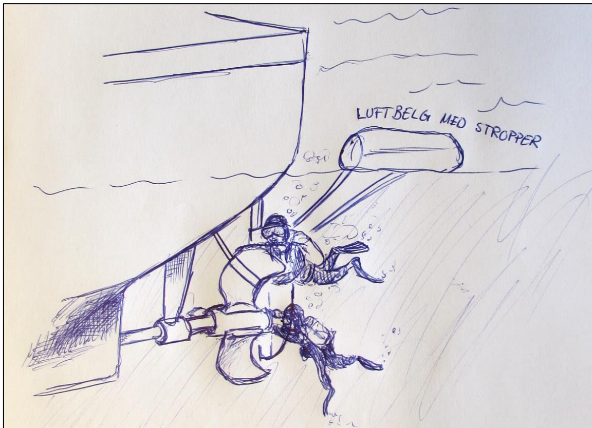
Figur 6- Eksempel på hvordan bytte av propellblader kan gjennomføres med dykkere
