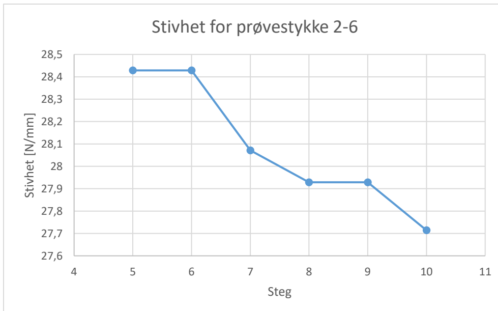
Figur 46-Stivhet for prøvestykke 2-6 ved 14mm nedbøyning
