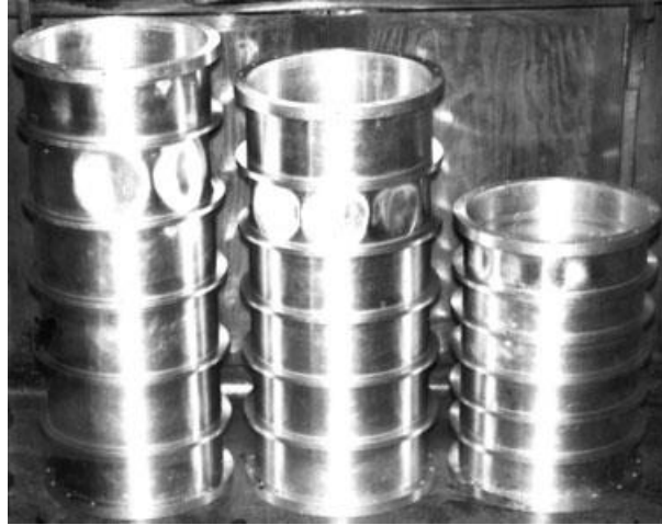
Figur 7. Buckling mellom spant
