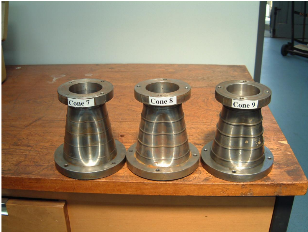
Figur 8. Trykket bidrar til at den koniske sylindere i dette tilfellet imploderer over ringstiverne.
