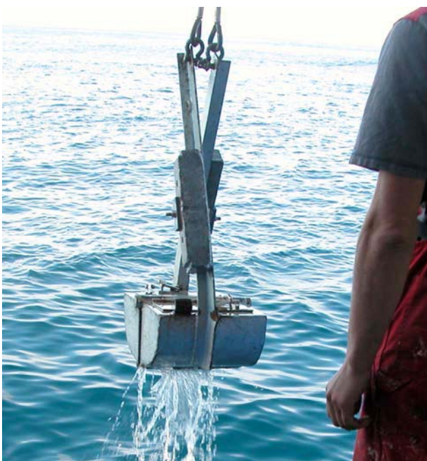
Fig. 4. The Van Veen grab used on P325.
