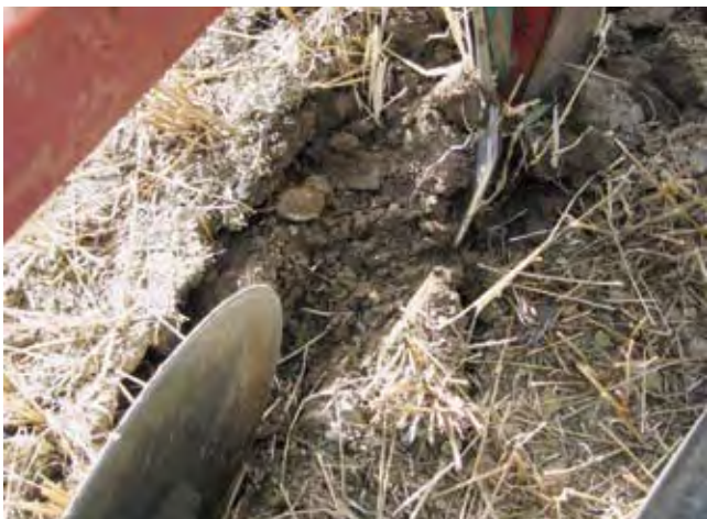
Figur 35. Rulleskjæret står for nære, det skjærer innenfor brøstet. Kanten på det oppløyde vil bli rufsete fordi det er brøstet som river i kanten på det oppløyde. Foto: Kjell Mangerud.
