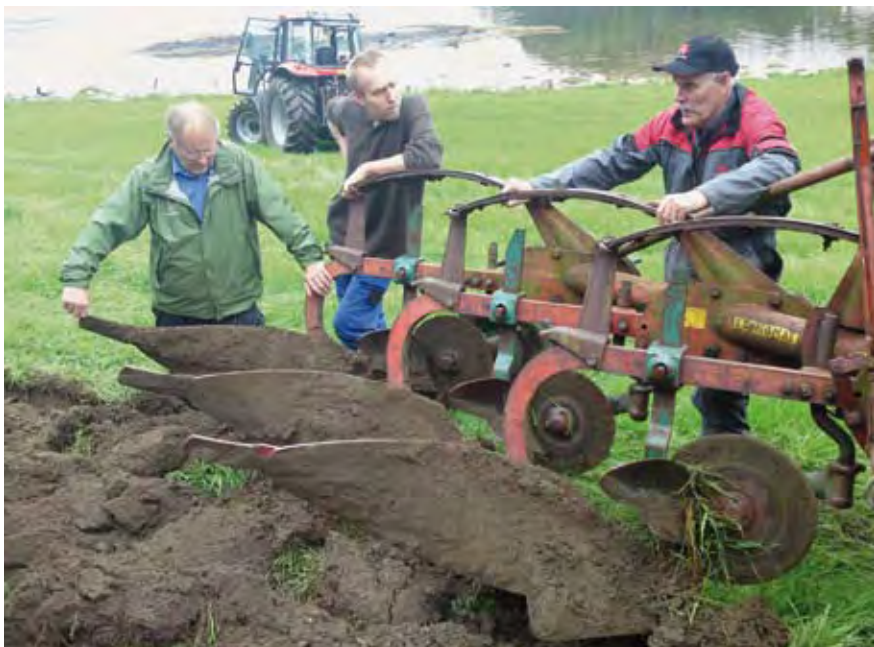
Figur 7. Når jorda kleber og plogen er rustet, blir resultatet ubrukelig. Foto: Ole Inge Edvardsen.
