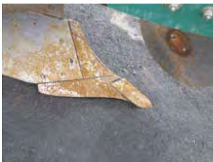
Figur 5. Her må skjæret skiftes. Det har allerede blitt slitasje på salen, og skjæret er så smalt at det ikke blir tilstrekkelig gjennomskjæring og det vil være problemer når en skal velte oppover bakke. Spissen er slitt så mye at den må snus. Foto: Kjell Mangerud.
