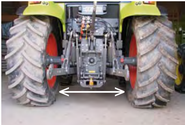
Figur 22. Avstanden mellom innsiden av bakdekkene (målt på utbulingen) bør være tre ganger veltebredda pluss 2 til 11 cm. For en 14" plog som velter 35 cm, bør denne avstanden være mellom 107 og 116 cm. Om det avviker noe, kan en forskyve plogen sideveis på dragakselen. Foto: Kjell Mangerud.
