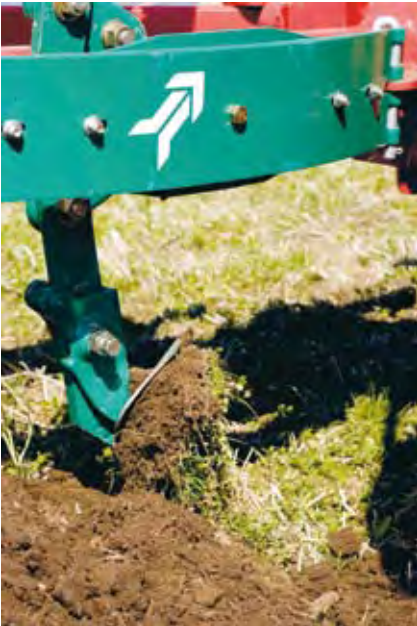
Figur 11. Forplog i arbeid. Her fjernes halmstubb og ugras. Dette kastes ned i bunnen av fåra.
