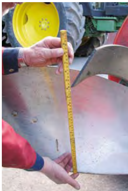
Figur 28. En kan kontrollere at skumfjølene står like høgt ved å måle fra undersiden av velteffjola til spissen på skumfjola. Foto: Stein Jørgensen.
