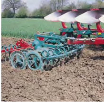
Figur 21. Har en jordpakker med tinder, kan en få ferdig såbed samtidig med at jorda blir pakket.
