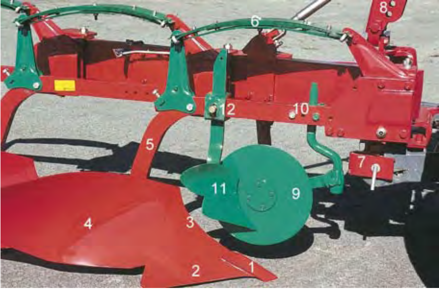
Figur 2. 1. Spiss, 2. Skjær, 3. Brøst, utskiftbart brøststykke, 4. Veltefjøl, 5. Ås, 6. Utløserfjær, 7. Dragaksel, 8. Tårn, 9. Rulleskjær (Skiveristel), 10. Feste for rulleskjær, oppstanderen som går gjennom festet gir mulighet for dybdeinnstilling og stilling av rulleskjæret sideveis, 11. Forplog, 12. Feste for forplog, dette kan flyttes frem og tilbake og forplogen kan stilles i høyden.
