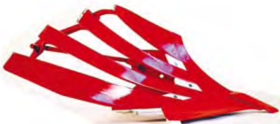
Figur 19. Stripekropp er et godt alternativ på morenejord som kleber på vanlig veltefjøl av stål.
