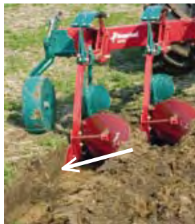
Figur 33. Bakre ende av landsida skal ha en klaring til bunnen etter spissen på 1 - 2 cm. Her er toppstanga litt kort og klaringa litt stor.
