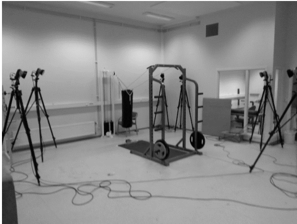
Figur 1. Forsøksoppsett. Heavy-bag i midten som testpersonene sparket sine testspark på. Baggen ble festet til fire punkter på hver sin side av vektløfting stativ for å unngå at baggen roterer rundt sin egen akse etter spark. Det ble lagt på 120kg ekstra på det ene vektløftingsstativet for å øke dets stabilitet. Rundt test-området står det seks 3D kameraer.
