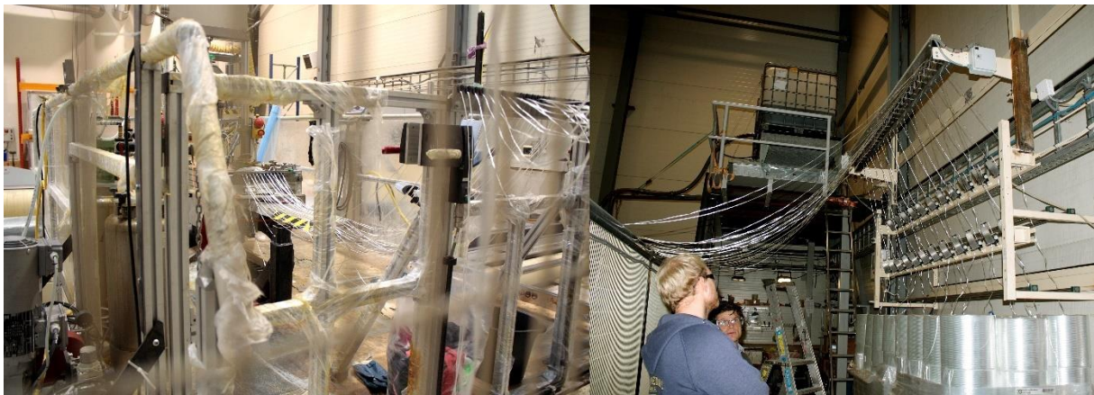
Figur 9.2 Fibervikling hos OPS, med fiber til høyre, og resinbad og mandrill til venstre
