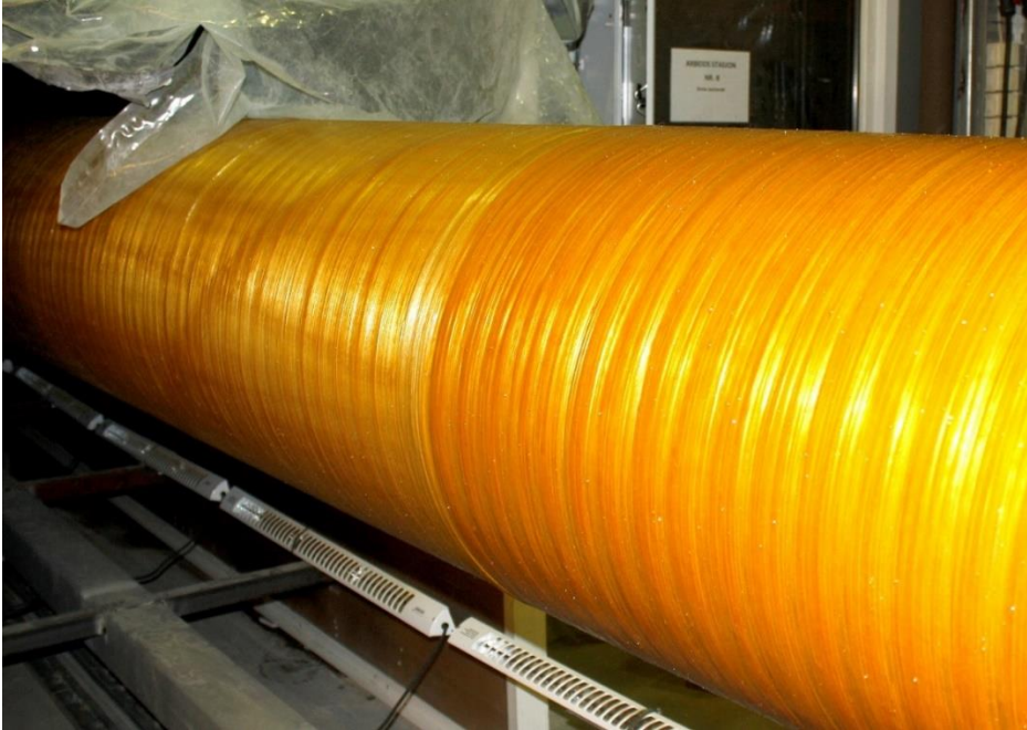
Figur 9.4 Fiberviklet høyspentmast hos OPS
