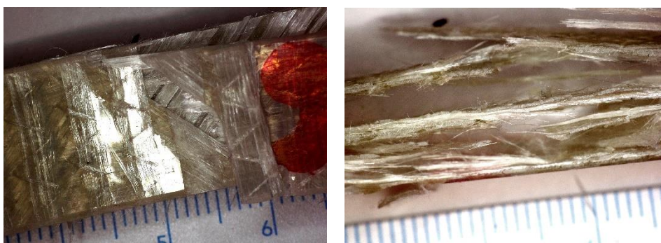
Figur 12.11 V-1 prøvestykke som har vært strukket til brudd.
