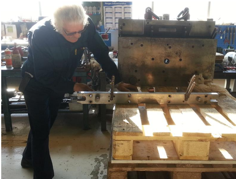
Figur 21: Daglig vedlikehold av formverktøy ved vedlikeholdsavdelingen, i Leksvik.
