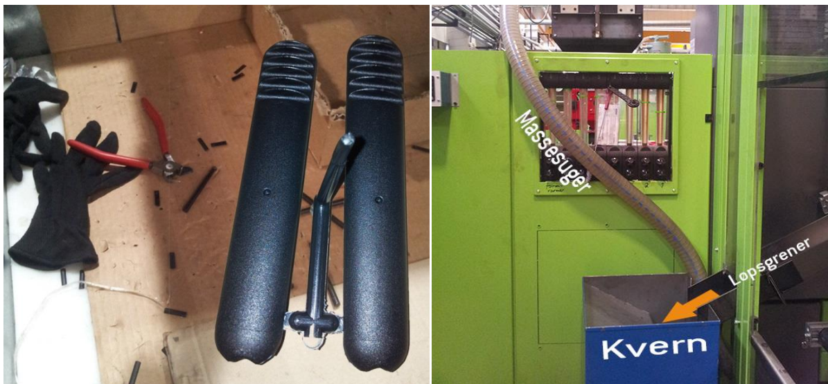
Figur 23: Løp ved produkter som fjernes manuelt vha. tang, og tilhørende massesuger for kverning av løpsgrener til termoplast.
