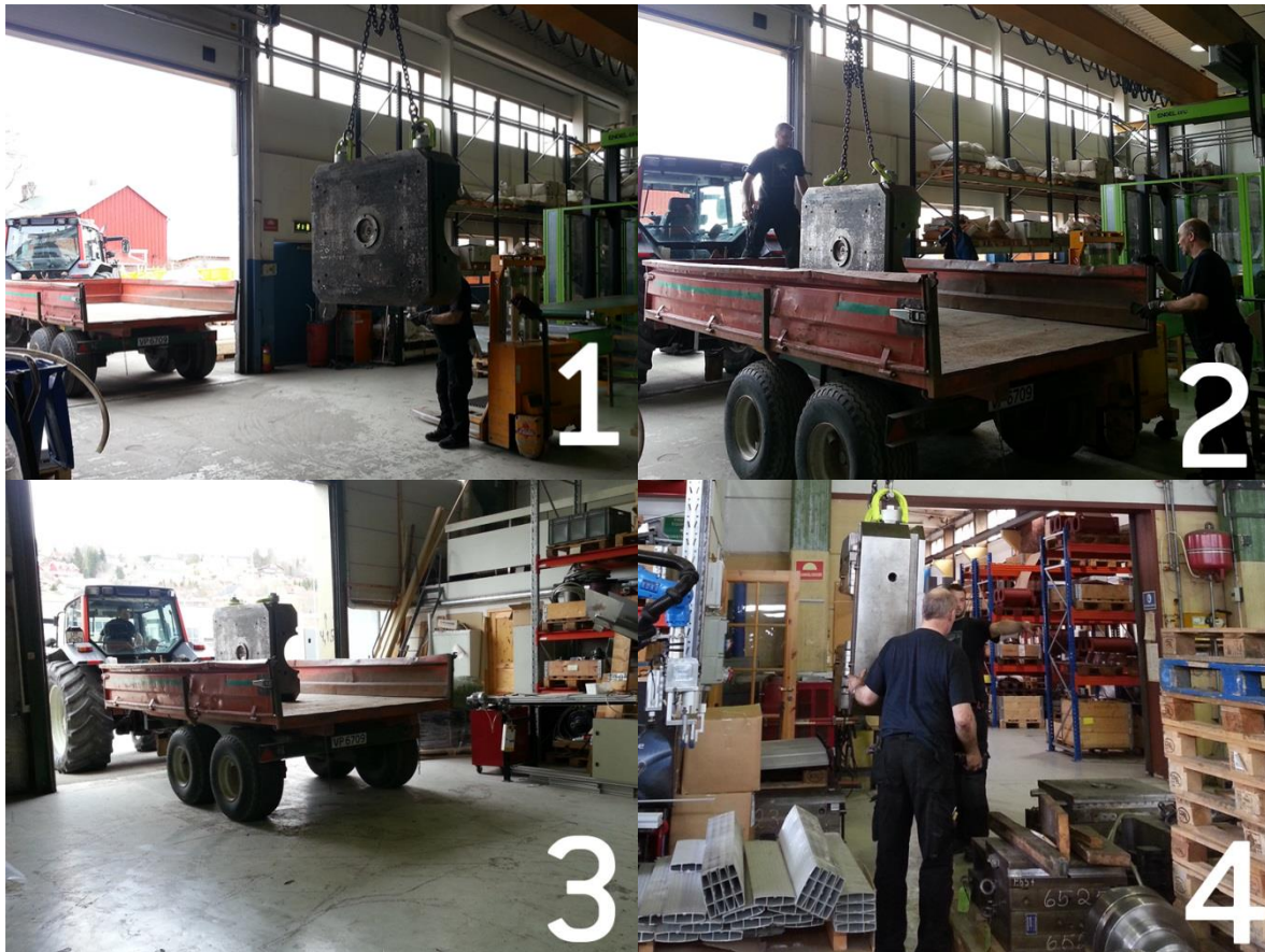
Figur 25: Making-do utførelse av formskifte av tyngre former (over 2 tonn).
