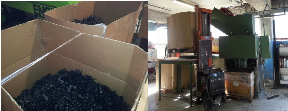
Figur 24: Vrakdeler og løpsgrener samlet for felles kverning til ny termoplast.
