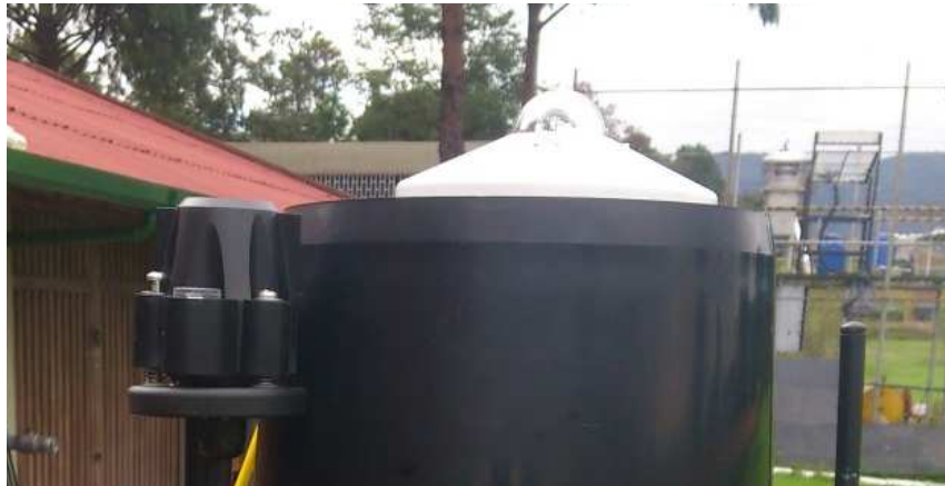
Figura 15. Sensores de radiación - Estación meteorológica Davis Vantage Pro 2 plus y Piranómetro KIPP & ZONEN CMP3.
