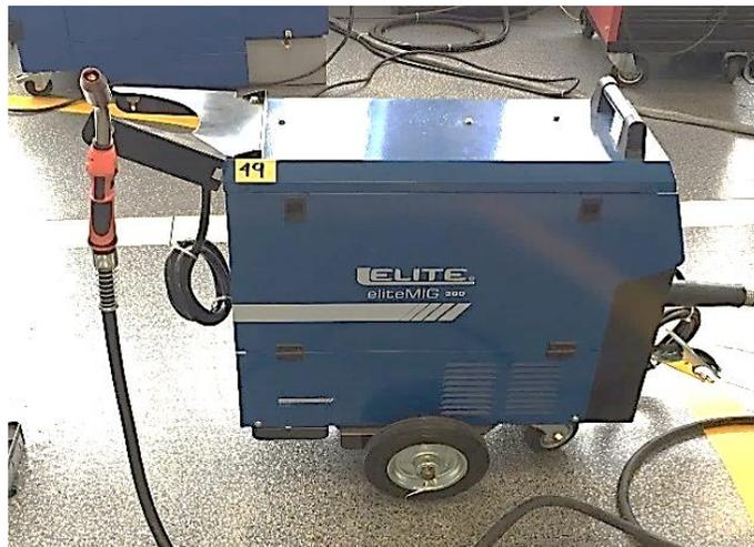
**FIGURA 4. EQUIPO DE SOLDADURA (MIG/MAG).**
