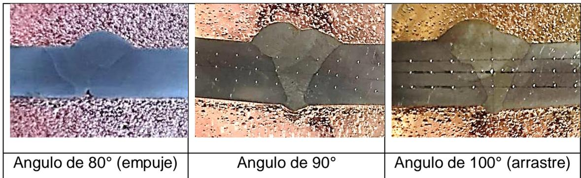
FIGURA 40. SOLDADURA CON VARIACIÓN DE ÁNGULO DE ANTORCHA.
