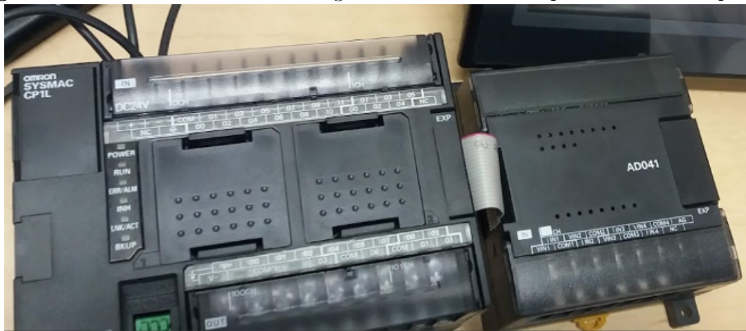
Figura 25: Módulo de entrada analógica conectado a PLC por medio de adaptador.
