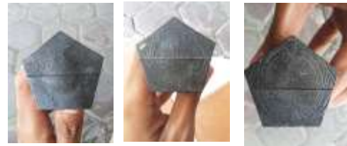
Gambar 7. Cacat warping pada produk tekanan 80 Bar
