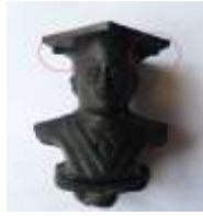
Gambar 8. Cacat flashing pada produk
