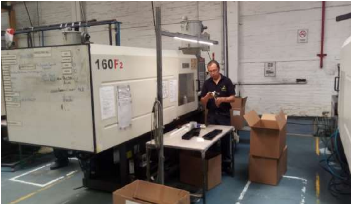
Figura 3. Medición y control del producto inyectado (perilla). El autor, año 2019
