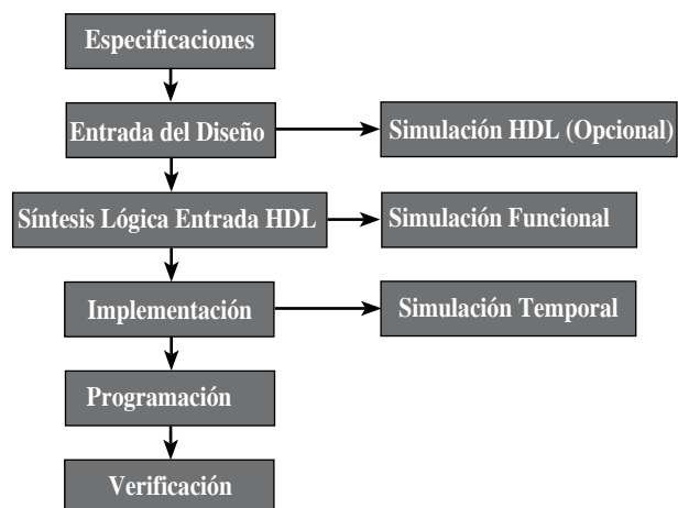
Figura 1. Flujo de diseño de un sistema digital, haciendo uso de herramientas EDA.
