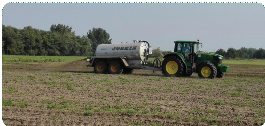
11. kép: A leszorítva kijuttatott hígtrágya ammóniakibocsátása kisebb
