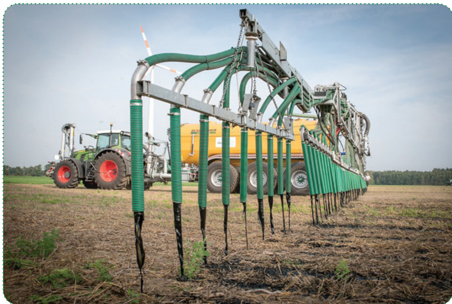
12. kép: Csúszócsoves technológia kijuttatás közben
