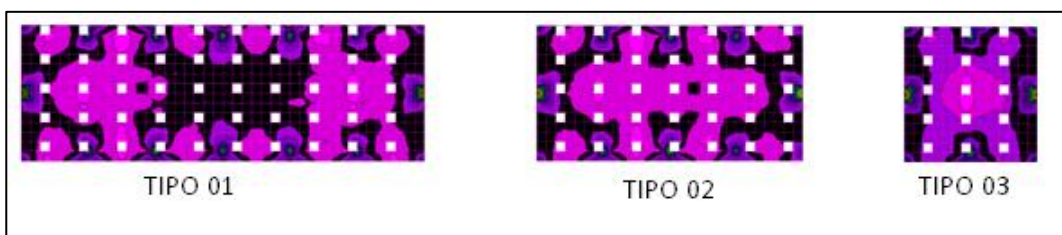
Figura 85: Esquema de visualização do comportamento do Mx nas lajes com furos simétricos
