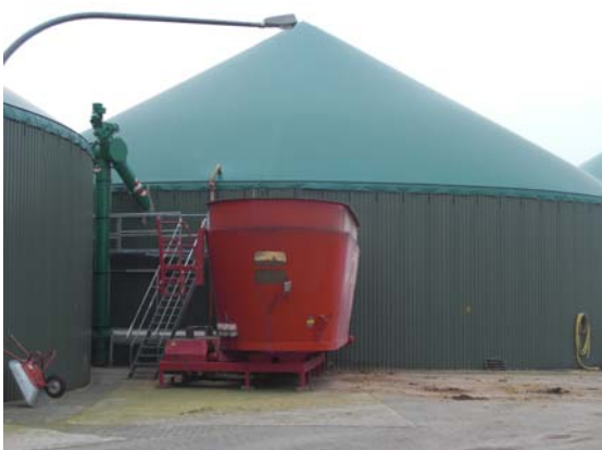
Abbildung 15: Fütterungssystem auf Untersuchungsbetrieb B
