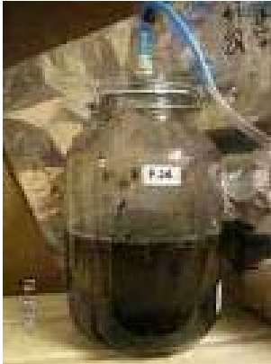
Abbildung 18: Gärversuch im Batchfermenter
