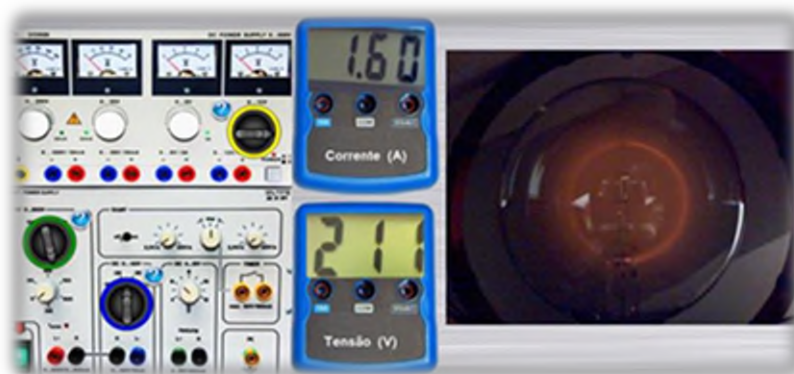
Figura 36: Layout do painel que utilizamos para controlar o experimento da figura 35, a imagem ao lado direito dos objetos de medição (multímetros) é exatamente a resposta do experimento, assim como os números representados nos multímetros. Fonte: A DESCOBERTA DO ELÉTRON COMO TEMA GERADOR DE UM ENSINO DE FÍSICA MEDIADO POR EXPERIMENTAÇÃO REMOTA (Cardoso, D. C., 2016).
