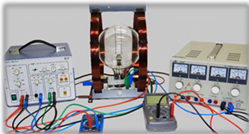
Figura 33: Experimento carga/massa do elétron. Fonte: A DESCOBERTA DO ELÉTRON COMO TEMA GERADOR DE UM ENSINO DE FÍSICA MEDIADO POR EXPERIMENTAÇÃO REMOTA (Cardoso, D. C., 2016).
