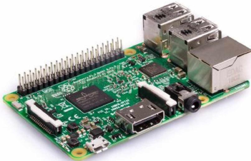
Figura 4 – Raspberry Pi 3 modelo B
