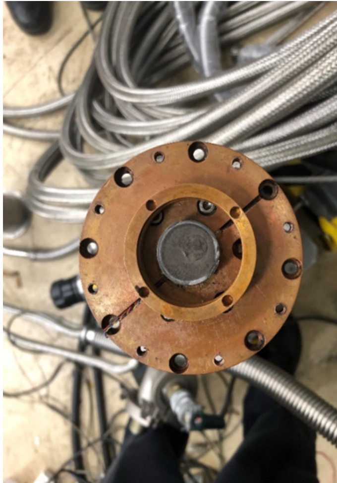
図 2.14: 冷凍機に取り付けたバルク外観
