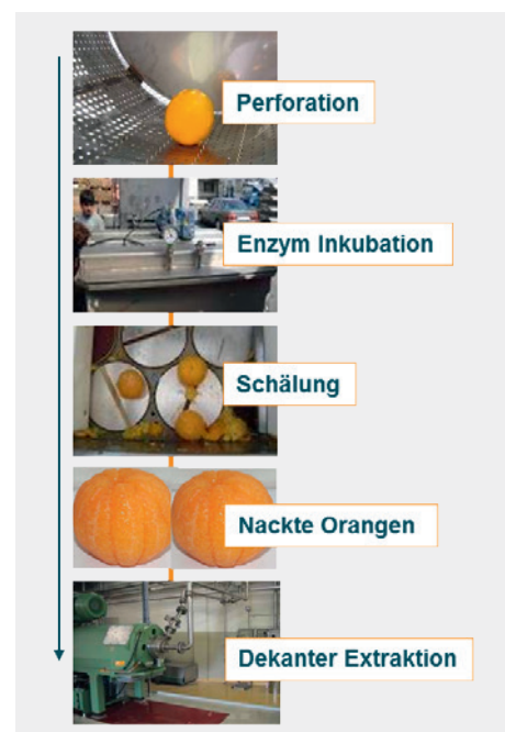
Abb.1: Verfahrensablauf bei der enzymatischen Schälung und Gewinnung von Orangensaft.
