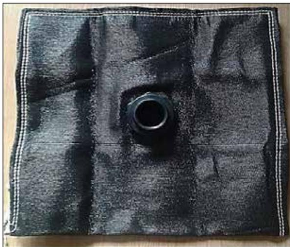
**Figura 1** - Saco geotêxtil (geomembrana)
