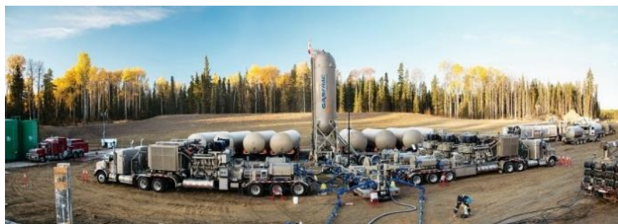
Figura 2.43. Fracturación “seca”, utilizando gas. Fuente Gas-Frac 21
