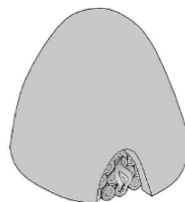
Figura 6. Horno de colmena para la producción de carbón por medio de la pirólisis lenta
