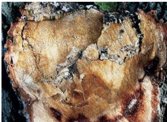
Figura 20. Putridión blanda en un tronco de madera [40]
