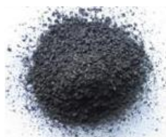
Figura 29. Fracción sólida generada durante la pirólisis [64]
