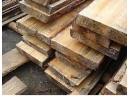
Figura 16. Coloración producida por los Hongos cromógenos en tabla de pino caribe [11]
