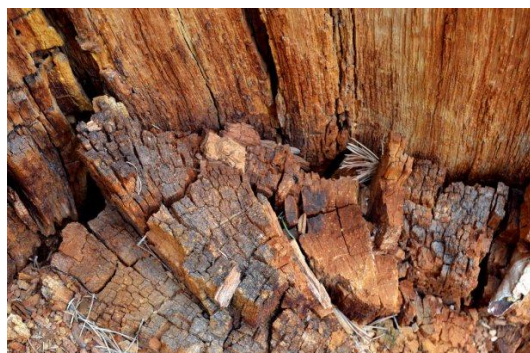
Figura 17. Acción de la pudrición cúbica sobre un abeto [22]
