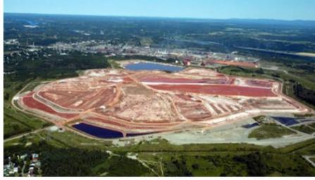
**Figure 7.** Vue aérienne du site de disposition de résidus de bauxite (SDRB) illustrant les différents secteurs délimités correspondant aux différentes étapes d'assèchement.
