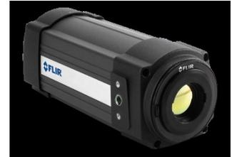
La fenêtre en germanium a une transmission maximale (~50%) dans la plage de 2-13  $\mu\text{m}$ , ce qui permet au rayonnement thermique incident de s'introduire dans la caméra thermique, mais au rayonnement visible d'être filtré avant d'atteindre le détecteur.
