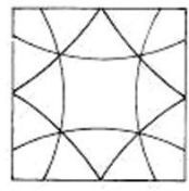
Bóveda de arcos entrecruzados
