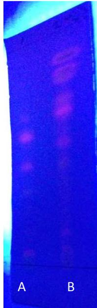
Gambar 7. Kromatogram KLT sebelum kromatografi kolom vakum (KKV) dengan eluen N-hexan: etil asetat (7:3): A) Ekstrak Etanol Daun Lada dan B) Ekstrak Etil asetat Daun Bila.
