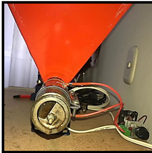
Figura 13 Estructura de la extrusora, vista frontal
