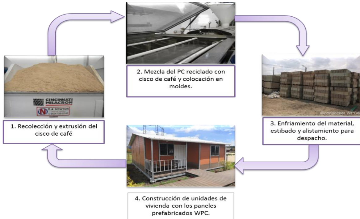
Fig. 8 Proceso de fabricación material WPC.
