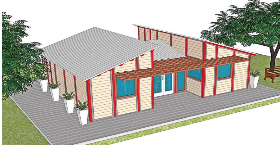
Fig. 5 Puesto de salud de 67 m 2 elaborado con material WPC
