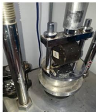
Carga a tracción indirecta Briqueta 1
