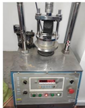
Carga a tracción indirecta briqueta 3
