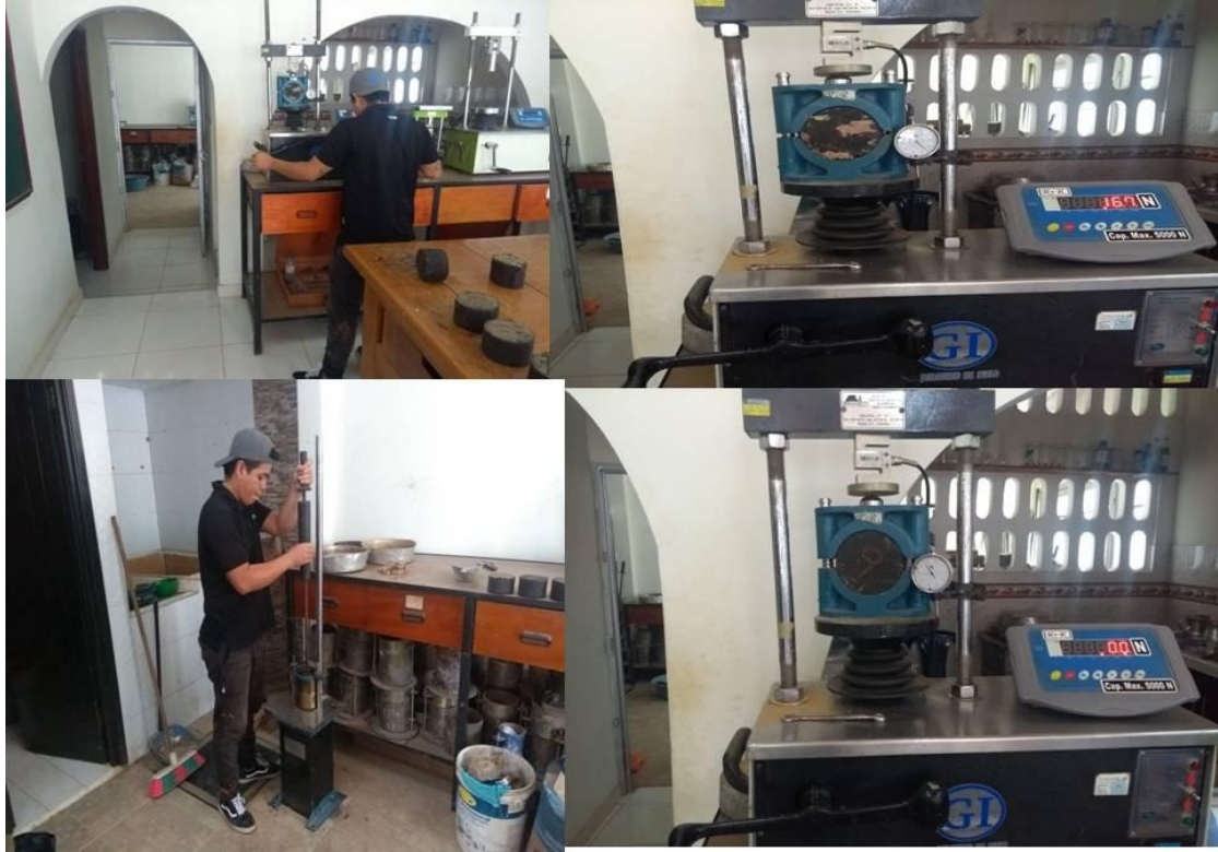
Imagen 3 Elaboración de briquetas de ensayo y Ensayo Marshall
