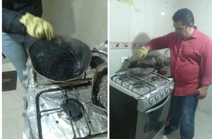
*Figura 8. Calentamiento de la arena y la grava con adición de asfalto y aceite reciclado*
