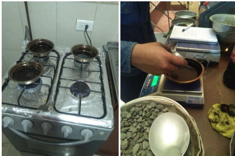
*Figura 7. Calentamiento del bitumen con adición de aceite reciclado*
