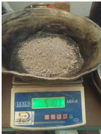
*Figura 5. Control del peso de la arena seca*
