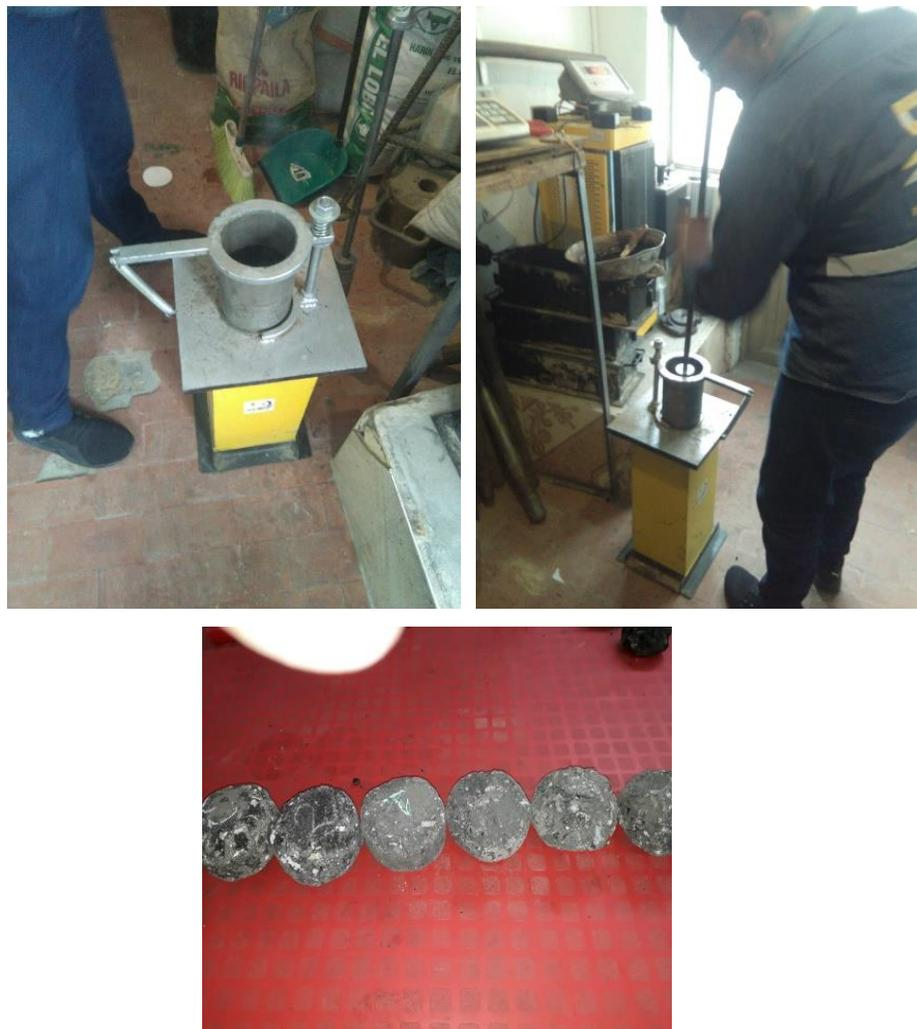
*Figura 10. Armado de briquetas*
