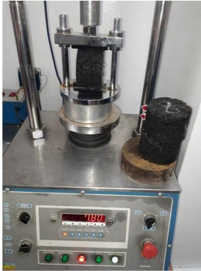
*Figura 11. Ensayo a la tracción indirecta*
