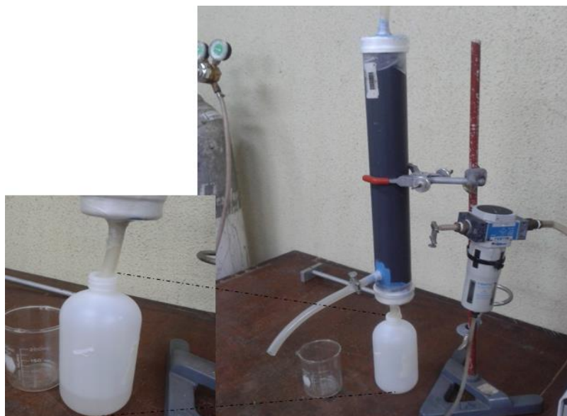
Figura 11. Celda de humedad y recolección de la muestra Lix 1 en el laboratorio de Radioquímica del CIRA/UNAN-Managua el 28-08-2015.
