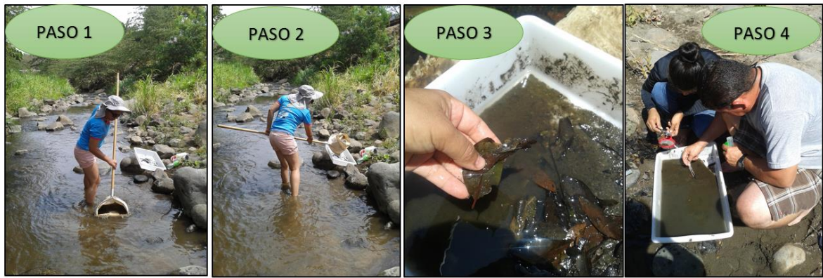
Figura 29. Primeros cuatro pasos del muestreo con Red D en el Río San José. Marzo, 2016.
