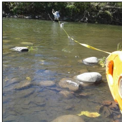
Figura 28. Medición de la máxima ribera en el río Cañas, punto 7. Época seca, 2016.
