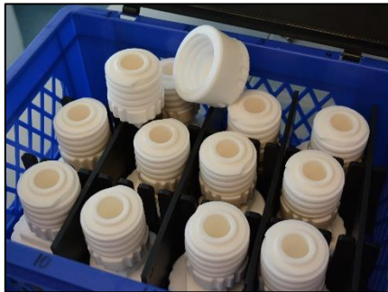
Figura 33. Bomba de digestión de muestras orgánicas, laboratorio del Departamento de Ciencia Ecológica, Facultad de la Tierra y Ciencias de la Vida, de la Universidad Libre en Amsterdam, Países Bajos, 2016.
