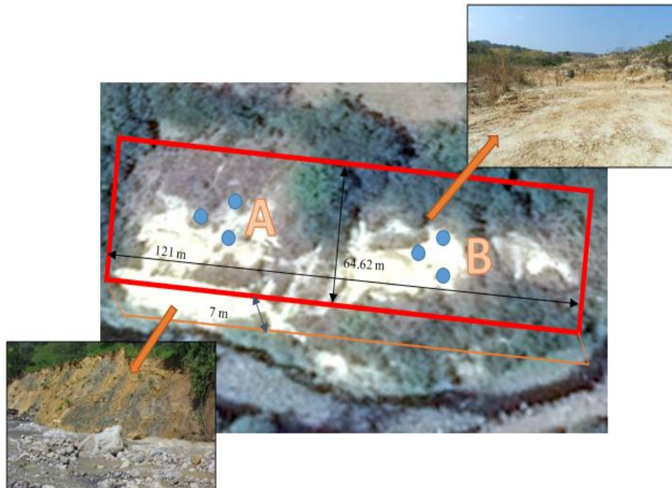
Figura 35. Dimensiones de las lamas y áreas de muestreo (A y B) en donde fueron colectadas las muestras compuestas de lamas (Lib A y Lib B), Líbano de Tilarán. Julio, 2014.
