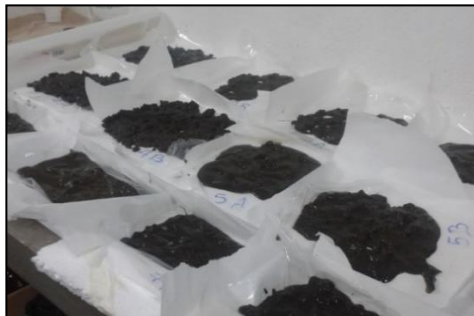
Figura 21. Secado de muestras de sedimento en el laboratorio Físico Químico del HIDROCEC, 2015.
