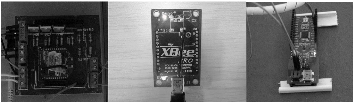
Figura 8 Componentes Red Zigbee. a) Dispositivo final, b) Coordinador c) Dispositivo final.
