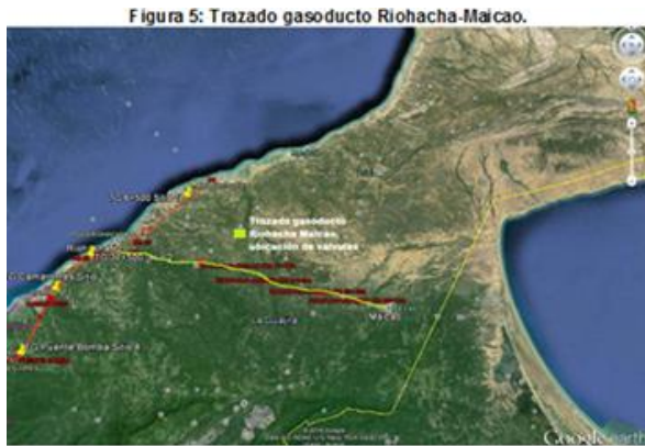
Figura 5: Trazado gasoducto Riohacha-Maicao.
