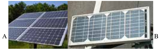
Figura 6: Tipos de paneles solares: A: Panel mono cristalino B: Panel Poli Cristalino (Solares,2013)
