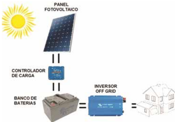
Figura 3. Componentes del sistema Off Grid.
