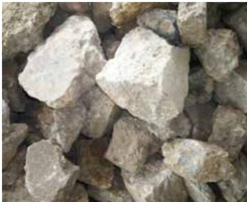
Figura 1. Agregado reciclado proveniente de la antigua avenida Pedro de Heredia, Cartagena, Colombia
