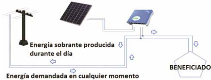
Figura 2. Componentes del sistema On Grid
