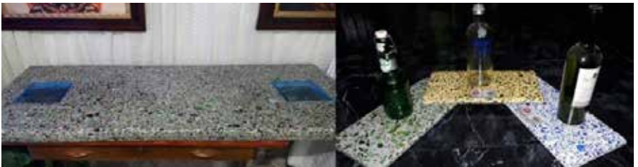
Figura 1. Mesones a base de vidrio reciclado utilizados en viviendas de interés social
