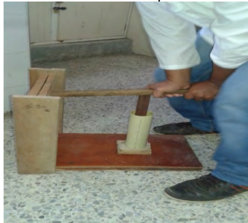
Figura 2: Prensa utilizada en la compactación de la mezcla.
