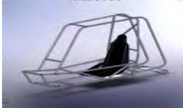
Figura 5: Modelo del Móvil Tipo Buggy en el Software Solid-Works
