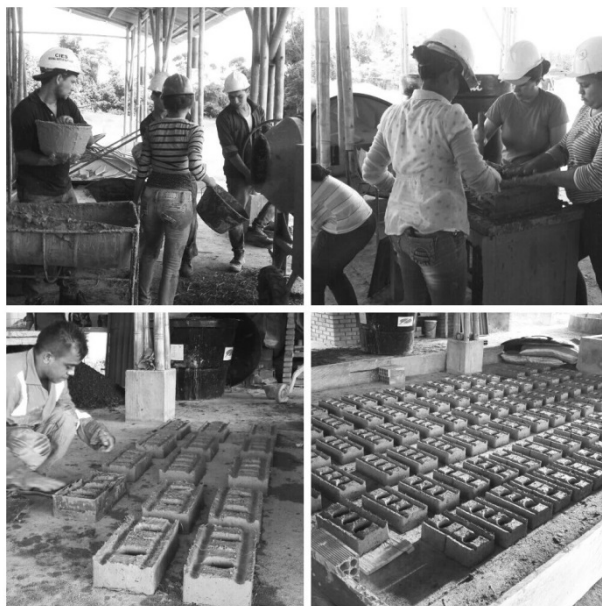
Figura 11: Elaboración de mampuestos
