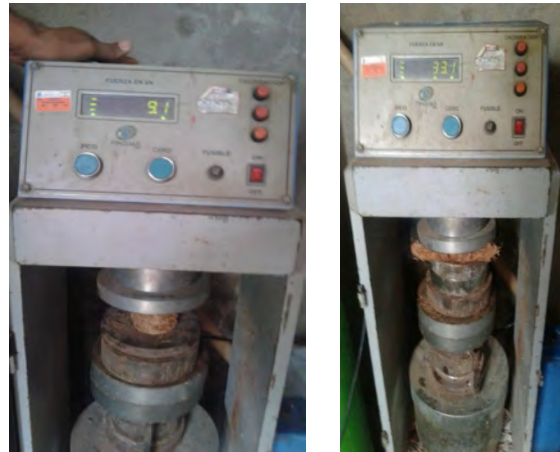
Figura 5: Fuerzas ejercidas sobre la briqueta.
