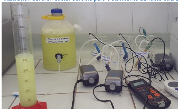
Ilustración 23. Biorreactor aerobio para tratamiento del lacto-suero
