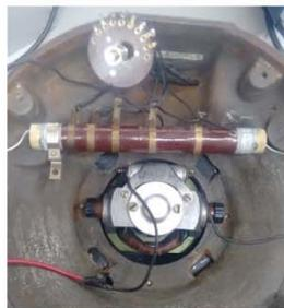
Estado inicial de la centrífuga con control manual de velocidad y sin control de tiempo.
