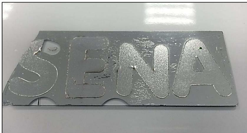
**Imagen 2.** Recubrimiento de película delgada de Aluminio sobre sustrato de vidrio
