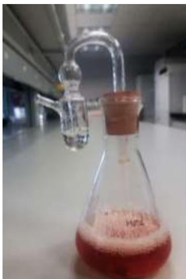
Figura 7: Microfermentador con válvula Müller
