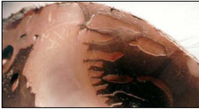
Imagen 6. FAC en fase dual, mostrando los característicos valles (también llamados "piel de tigre"). (Field Guide FAC and erosion. EPRI [13])
