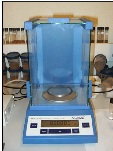
Imagen 13. Balanza para medición de la masa con precisión de 0.00001 g. (Fotografía cortesía de la Escuela Politécnica Superior Ferrol)
