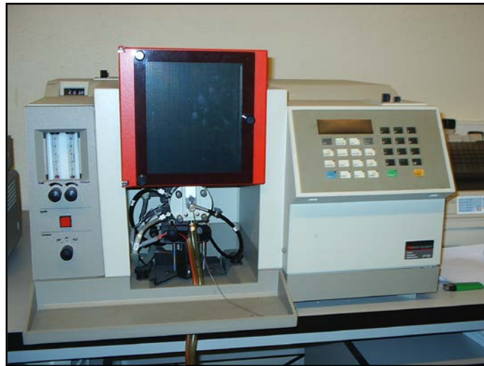
Imagen 8. Espectrofotómetro de absorción atómica. (Fotografía cortesía de la Escuela Politécnica Superior Ferrol)
