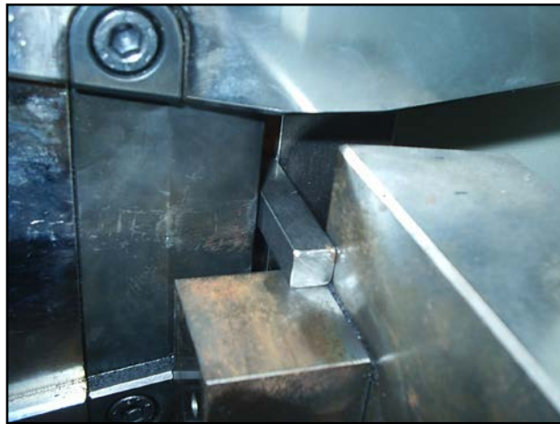
Imagen 14. Detalle de probeta Charpy en posición de ensayo. (Fotografía cortesía de la Escuela Politécnica Superior Ferrol).
