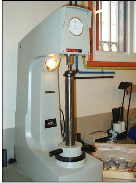
Imagen 11. Durómetro. (Fotografía cortesía de la Escuela Politécnica Superior Ferrol)
